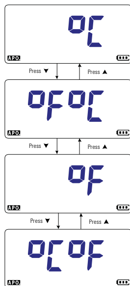
Figura 4-17 Alterar a unidade de temperatura
